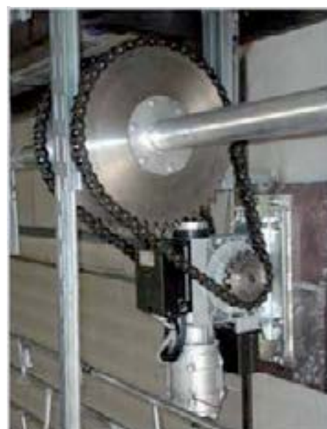
Particolare motore con rinvio a catena Detail of a chain - driven motor
